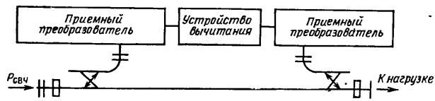
Рис. 3.18. Структурная схема прямопоказывающего ваттметра проходящей мощности.
